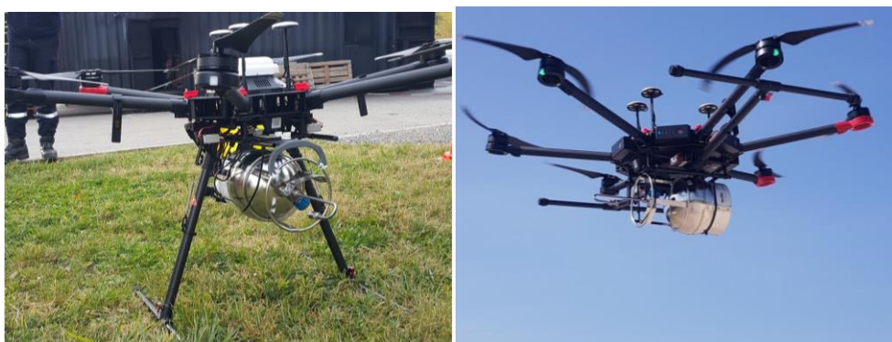
Figure 55 : Drone équipé d'un canister
