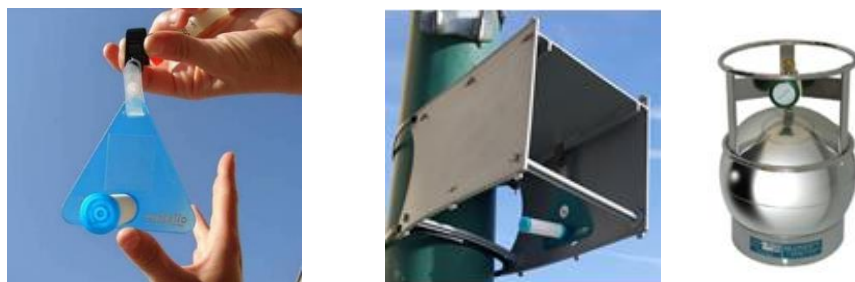
Figure 16 : Méthode de prélèvements COV par tube passif (à gauche) et canister (à droite)
