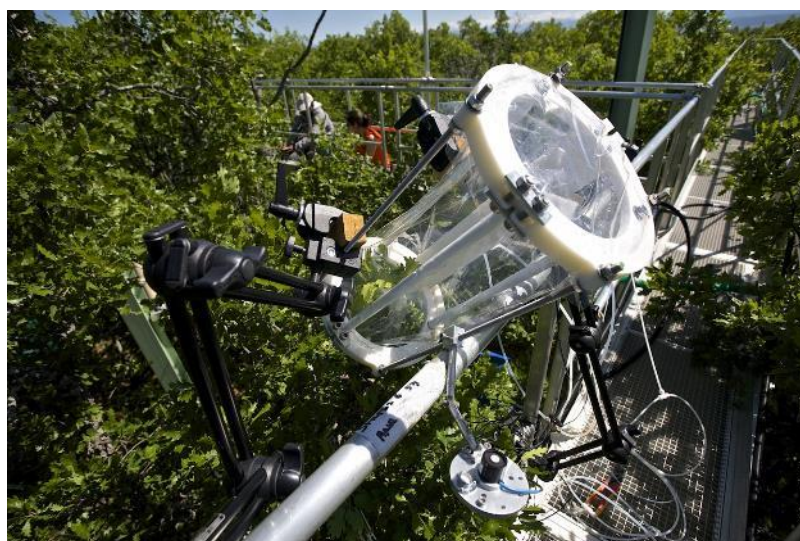
Figure 18 : Photographie d'une chambre d'enfermement dynamique mise en place sur la plateforme expérimentale de l'O3HP (Oak Observatory at the OHP), installée depuis 2009 sur le site de l'OHP
